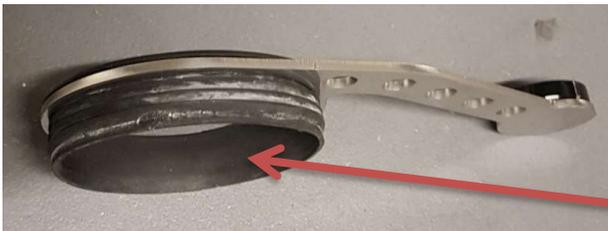
Den Gummispannring in den Halter montieren ggf. im inneren etwas leicht Creme einschmieren, dann rutscht es besser über das Uhrengehäuse.
